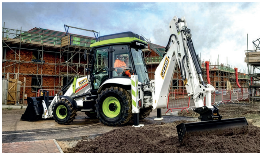
Com motor de 55 kW a hidrogênio , retroescavadeira 3CX Hydrogen promete potência e torque equivalentes ao diesel
