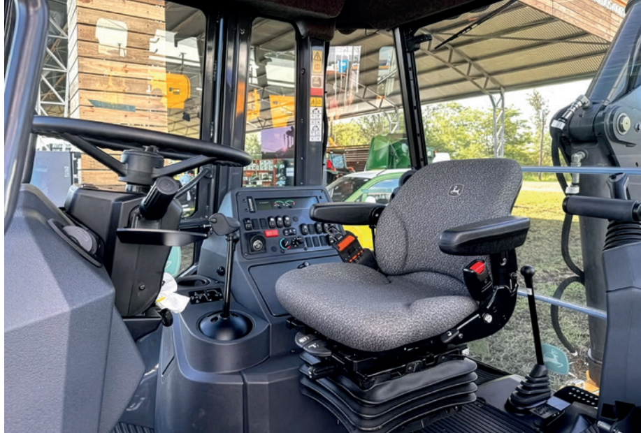
Aprimoramento da cabine da John Deere 310 P leva em conta características de operadores de diferentes regiões do mundo
