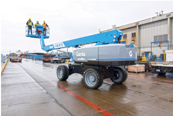
Destaque da Genie , o modelo elétrico S-85 XC FE utiliza baterias de íons de lítio de 48 V
