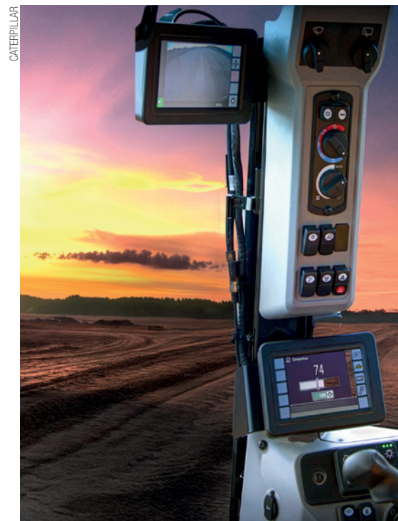
Tecnologias inteligentes como o sistema Machine Drive Power (MDP) medem em tempo real a compactação atingida
