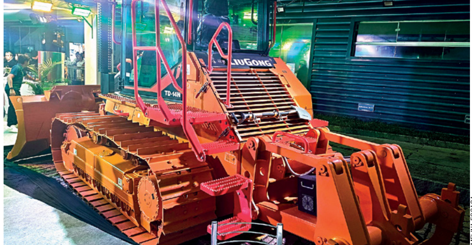
Com peso operacional de 16.140 kg, trator de esteiras TD14N é equipado com motor a diesel QSB 5.9
