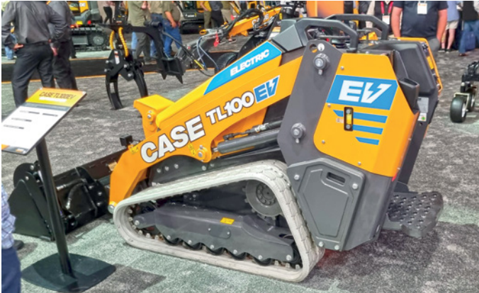
Estrela da Case , a minicarregadeira elétrica TL100EV opera com três motores elétricos
