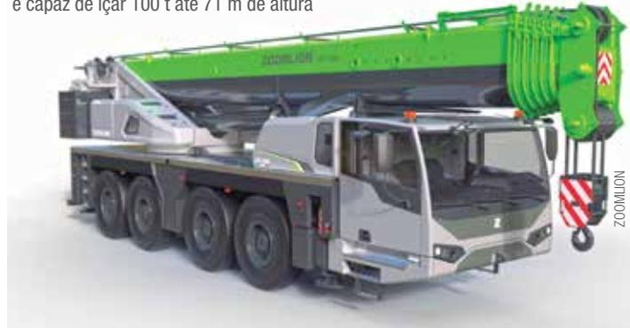
Em uma mostra focada nos clientes europeus, a marca expôs guindastes de torre, guindastes móveis e bombas montadas em caminhões. Projetado e construído na Itália, o novíssimo guindaste todo terreno ATC 1000 é capaz de içar até 100 t em extensões de até 71 m de altura, ganhando destaque no estande.
