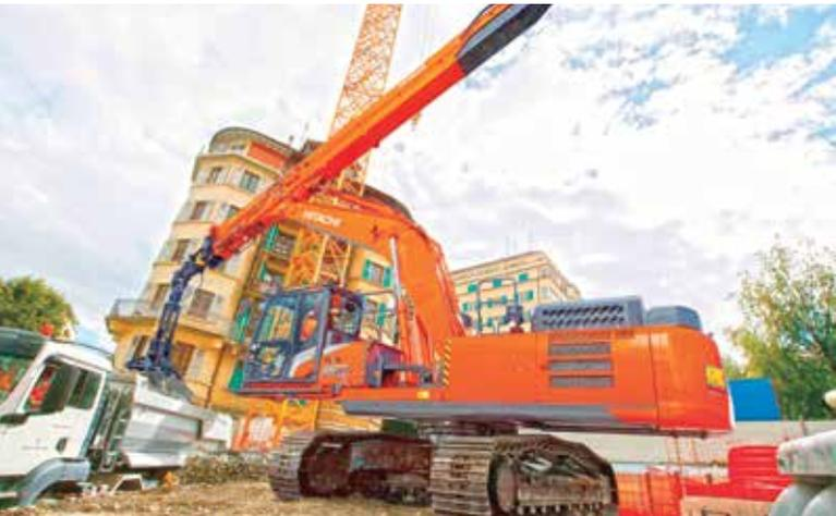
**Destaque da Hitachi**, a escavadeira de demolição ZX350-7 traz braço telescópico com alcance de 30 m
