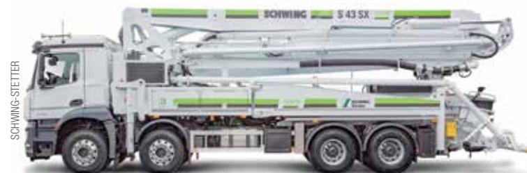
**Destaque da Schwing,** a nova bomba híbrida sobre caminhão S 43 SX tem alcance de 42,3 m
