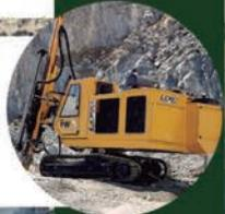
Giro dos Chassis e Boom Extensivo, proporcionando até 3 furos sem mover as esteiras.
