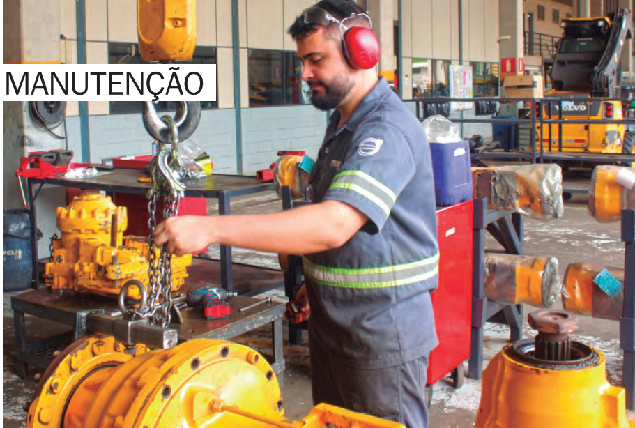
Em geral , as intervenções em eixos se resumem a trocas de rolamentos, vedações e ruelas
