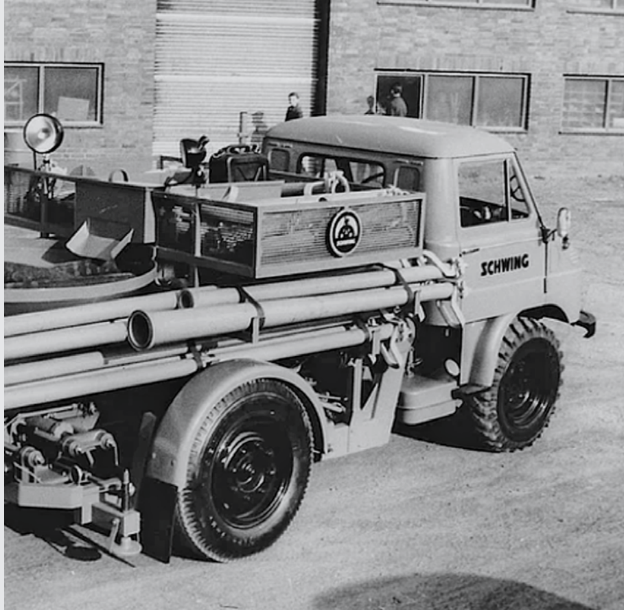
Após a invenção, em 1957, a bomba hidráulica de dois cilindros com movimento alternado foi adotada pela maioria dos fabricantes em todo o mundo
