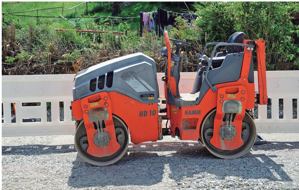
**Modelos como o Hamm HD 10** contam com deslocamento lateral do eixo traseiro, o que permite compactar trechos rentes a muretas
