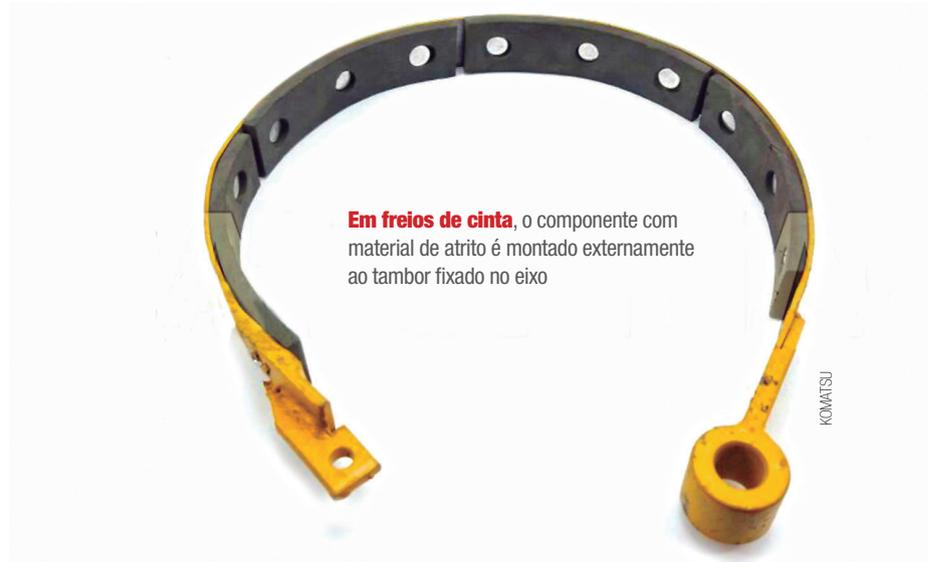
**Em freios de cinta**, o componente com material de atrito é montado externamente ao tambor fixado no eixo
