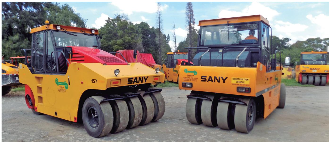
Equipamentos da Sany são dotados de direção hidráulica com articulação do eixo dianteiro
