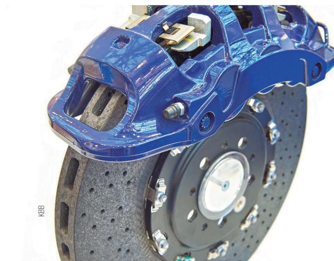
**Freios a disco contêm um disco de cerâmica ou ferro fundido** acoplado ao eixo, assegurando melhor desempenho na frenagem
