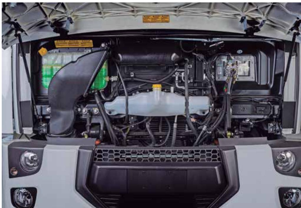
**Aposta da Ford** no segmento de médios, o novo Cargo 2431 possui motorização Cummins de 306 cv
