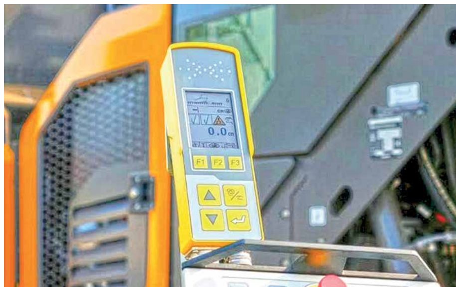
Sensores ultrassônicos criam referência virtual mais estável, reduzindo a influência de irregularidades da superfície
